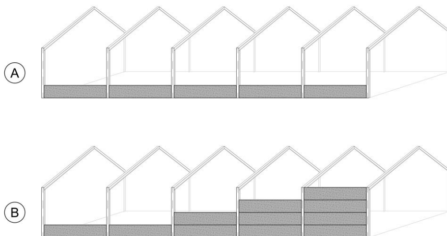
Gedeelte van staalconstructie van stal met rondom plintpanelen (A) en een deel gestapelde panelen (B).
